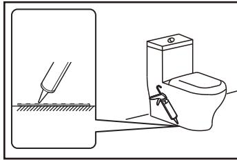
5. 将安装了密封圈的座便根据标记位置进行正式安装，将座便下压到位后，将地面与座便底部擦拭干净用玻璃胶进行密封。（待玻璃胶完全凝固之后方可正常使用）
