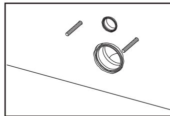
1. 座厕安装前，请确保隐蔽式水箱施工完成。隐蔽式水箱的安装请按照专用施工说明书进行安装。座便器安装孔中心距 $230 \pm 5$ 。
