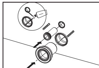
3. 在水箱供水、排水管内部的密封处涂上硅油之类的润滑剂，并插紧供水排水管。
