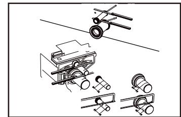
2. 切割供排水管，将进直管插入内管道直到不能前进画出管与墙面交界线。将直管插入座便器直到不能前进画出直管与座便器后端交界线。直管长度等于前面两次所画线到两端的距离之和，将锯口处挫出45°角方便插入管道。
