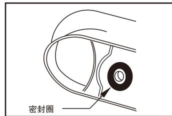
4. 试装无异常后，将座便放于地上（地上应有软垫，如产品的包装纸皮），在座便排污口处贴上密封圈。
