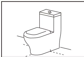
3. 安装并调节好水箱配件和马桶盖板。根据前面已经画出的排污口中心线和标记进行试接座便。
