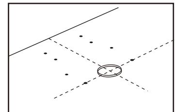
6. 选用合适的钻头分别为L形固定螺丝（2个）及塑胶管道固定螺丝打孔（6个）。
