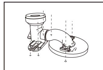
5. 将塑胶管道中心定位线与卫生间排污管的中心定位线完全重合之后，确认出塑胶管道安装螺丝的打孔位置（共6个）。
