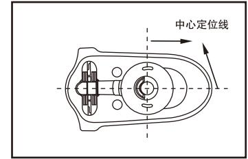
2. 将塑胶管道安装在陶瓷马桶上，确保塑胶管道底部与马桶底部平齐且左右对称，并参考塑胶管道排污口中心位置，在马桶和塑胶管道上向前后左右延伸画出中心定位线（为方便安装，可延伸到马桶底座外侧面）。
