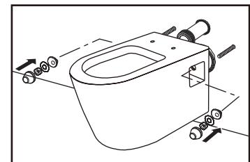
4. 将座便器固定孔套入固定螺杆，将座便器供水排水管紧密连接，并套入固定垫片、螺母等。
