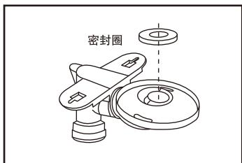
7. 在塑胶管道排污口处装上密封圈。
