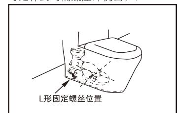
4. 将马桶底部（塑胶管道）的中心定位线与排污管的中心定位线完全重合之后，画出左右2个L形固定螺丝的位置（L形固定螺丝打孔位置在马桶外两侧各水平向内延约42mm）。
