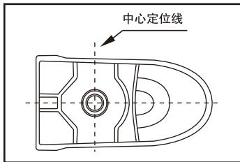
1. 在马桶底部排污口中心位置向前后左右延伸画出中心定位线（为方便安装，可延伸到马桶底座外侧面）。
