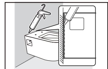
6. 座便器固定完毕后，在座便器与墙体的交接处涂上硅胶之类的密封材料。（注：禁止使用环氧树脂胶等硬化后体积变大的密封材料，由此引起的开裂我公司不负责任）。
