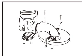
8. 用安装螺丝将塑胶管道固定在地面上。
