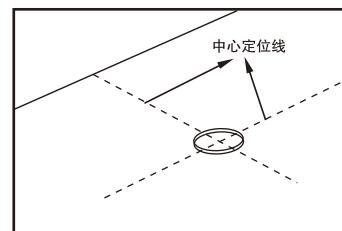
3. 在地面排污管中心位置向前后左右延伸画出大于马桶底座尺寸的中心定位线（需确认中心线方向）。
