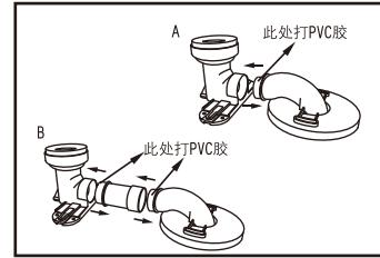
1. 确认卫生间排污管中心到墙的距离，若距离为305mm请按A方式安装塑胶管道，若距离为400mm请按B方式安装塑胶管道。（连接处打PVC胶）
