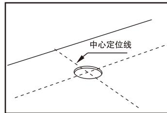
2. 在地面排污管中心位置向前后左右延伸画出大于座便底座尺寸的中心定位线（需确认中心线方向）。
