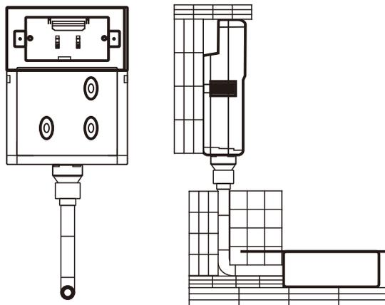
4. 根据墙的高度决定直管的长度
